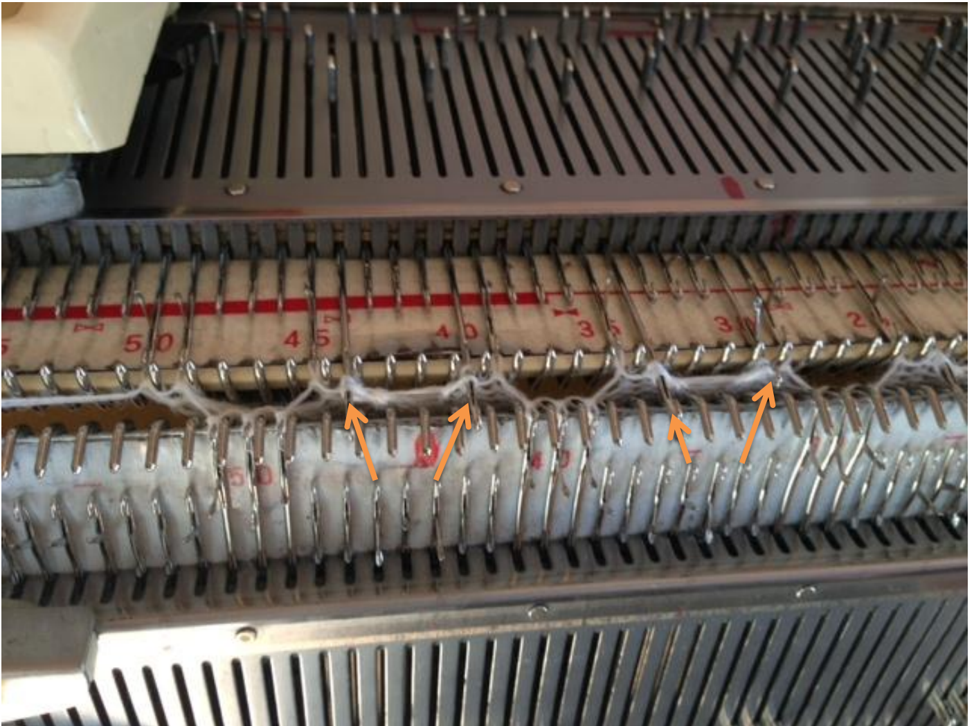
Altre due maglie spostare dalla seconda frontura alla prima e fare altro giro. (disegno C)
